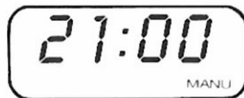
Erscheint in der Anzeige „AUTO“, ist die Automatik eingeschaltet. Der Rolladen hebt und senkt sich zu den eingegebenen Zeiten. Bei „MANU“ läßt sich der Rolladen nur durch Tastendruck bewegen. Der Rolladen kann auch im Automatikbetrieb manuell bedient werden.
