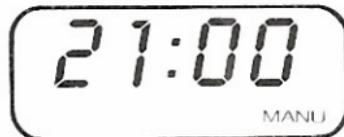
Erscheint in der Anzeige „AUTO“, ist die Automatik eingeschaltet. Der Rolladen hebt und senkt sich zu den eingegebenen Zeiten. Bei „MANU“ läßt sich der Rolladen nur durch Tastendruck bewegen.
